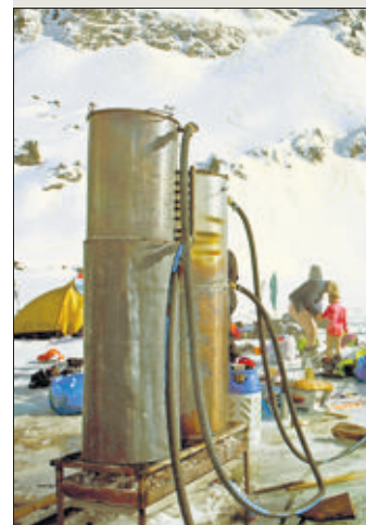
Les brûleurs ont chacun une puissance de 75 000 watts.
